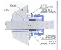
El más antiguo y aun el más común de estos dispositivos de sellado es el empaque de compresión, llamado así debido a la forma en que ejecuta la función de sellado. Hechos de materiales relativamente suaves y flexibles, los empaques de compresión o apriete,
