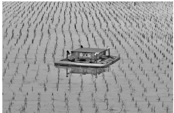
大学発ベンチャーとして開発中の、雑草を抑制するアイガモロボ
