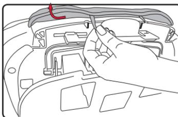
2. Accrochez les attaches de fixation à l'avant de la housse au bas de la coque du siège pour enfant.
