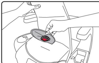
7. Tournez le dispositif de retenue de la boucle et faites-le passer à travers la fente de la coque du siège pour enfant.
