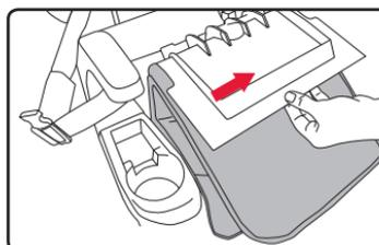
3. Tournez le dispositif de retenue de la boucle et faites-le passer à travers la fente de la coque du siège pour enfant.
