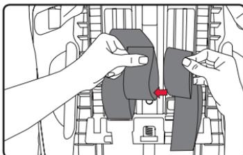
8. Retirez la fourche du harnais de sa fente de rangement sous la coque du siège et faites glisser complètement les sangles du harnais emboîtées sur la fourche du harnais.
