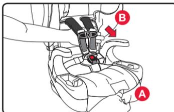
2. Débouclez le harnais, puis réglez le dispositif d'ajustement du harnais à la position la plus haute.
