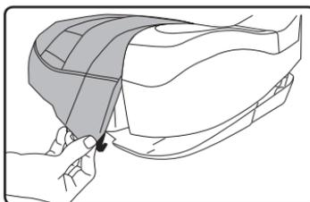
3. Tirez la housse du siège vers l'avant et faites passer le coussinet abdominal à travers la fente appropriée de la housse.
