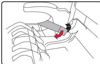
6. Décrochez les bandes élastiques à l'arrière de la housse du siège. Tirez la housse du siège vers l'avant et par-dessus le coussinet abdominal.
