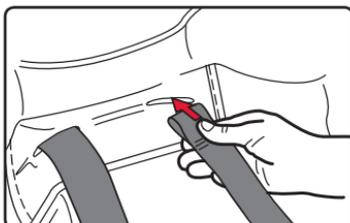
7. Emboîtez les sangles du harnais en insérant la boucle de la sangle droite dans celle de la sangle gauche.
