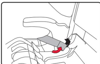
6. Insérez les sangles du harnais dans les fentes de la housse et de la coque, puis faites-les passer au-dessus de la plaque d'ajustement du harnais vers l'arrière du siège pour enfant.
