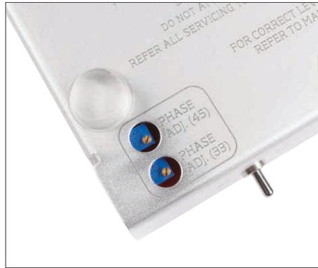
Die Phase der Motorspannungen ist für beide Tellerdrehzahlen getrennt justierbar
