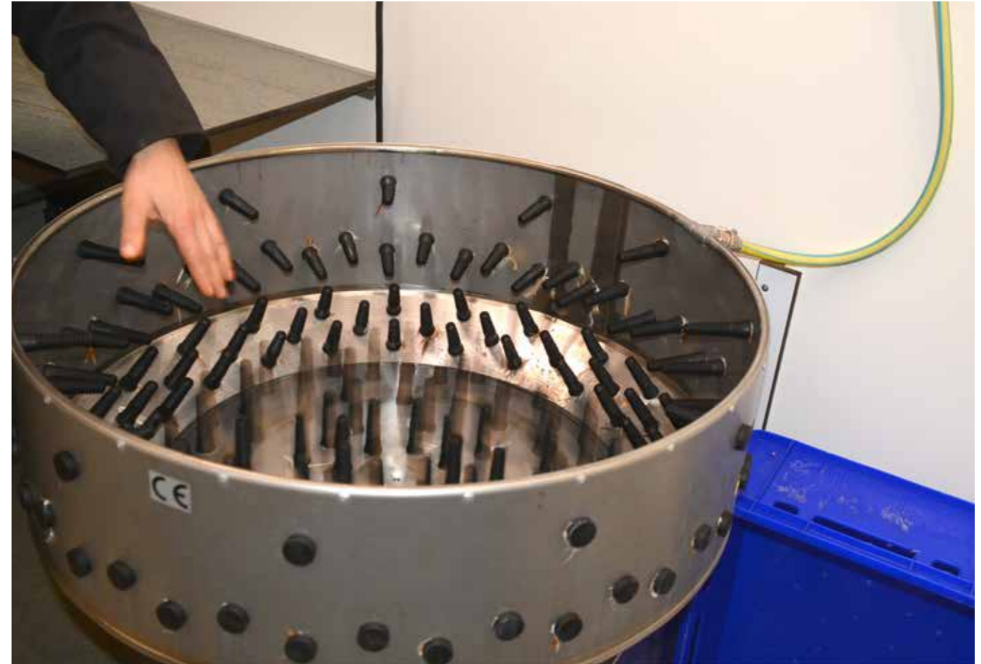
Plukkemaskinen, der fjerner fjer og dun fra kyllingerne. Foto: Henning Laen Sørensen
