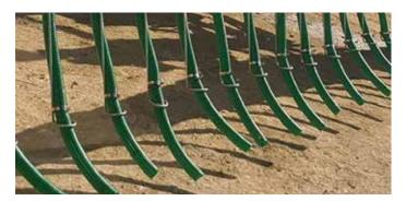
Schleppschlauchgestänge vollverzinkt, hydraulische Folgesteuerung für sichere Schließ- und Öffnungsfunktion, mech. Verriegelung der Klapparme, 5" Verteilkopf mit integrierter Schneideinheit, Schwergutabscheider, hydr. Sicherheitsventile mit Druckbegrenzungsfunktion, Schlauchabstand 30 cm, Schlauchführungen im Gestänge integriert (keine Knickung), Aufbau am Farmtech Fass.
