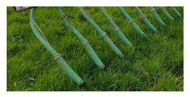
Schleppschlauchgestänge vollverzinkt, hydraulische Folgesteuerung für sichere Schließ- und Öffnungsfunktion, mech. Verriegelung der Klapparme, 5" Verteilkopf mit integrierter Schneideinheit, Schwergutabscheider, hydr. Sicherheitsventile mit Druckbegrenzungsfunktion, Schlauchabstand 30 cm, Schlauchführungen im Gestänge integriert (keine Knickung), Aufbau am Farmtech Fass.
