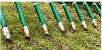
Schleppschuhgestänge vollverzinkt, hydraulische Folgesteuerung für sichere Schließ- und Öffnungsfunktion, mech. Verriegelung der Klapparme, 5" Verteilkopf mit integrierter Schneideinheit, Schwergutabscheider, hydr. Sicherheitsventile mit Druckbegrenzungsfunktion, Schlauchabstand 30 cm, Schlauchführungen im Gestänge integriert (keine Knickung), Aufbau am Farmtech Fass.
