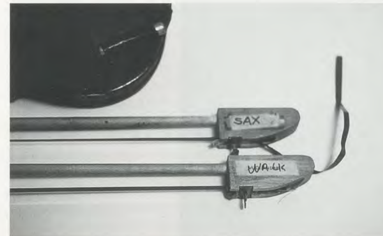
LAURIE ANDERSON, TAPE BOW VIOLIN, 1977, designed by Bob Bielecki, with a Revox tape playback head instead of the bridge, and a strip of pre-recorded audiotape on the bow instead of the horsehair / BANDBOGEN-GEIGE, mit einem Tonkopf anstelle des Stegs und bespieltem Tonband statt Rosshaar am Geigenbogen.
