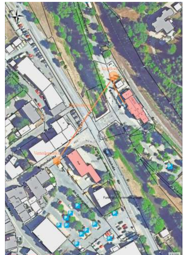
Trassenverlauf der Spülbohrung unter der Selbitz hindurch
