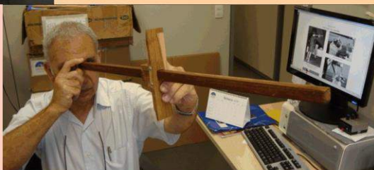
Avaliação do modelo pedagógico do instrumento de medidas angulares 'Balestilha' produzido no Laboratório Inovação em Recursos Educacionais do MAST (Foto: Acervo MAST, 2011).
