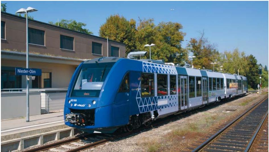
*Ein neuer LINT 54 von „vlexx“ bei einer Präsentation in Nieder-Olm. Gegenüber den LINT der Hessischen Landesbahn besitzen die neuen Fahrzeuge je Wagenkasten zwei Drehgestelle, sodass längere Fahrzeuge und die nachträgliche Einfügung eines Mittelwagens möglich sind Foto: fe*
