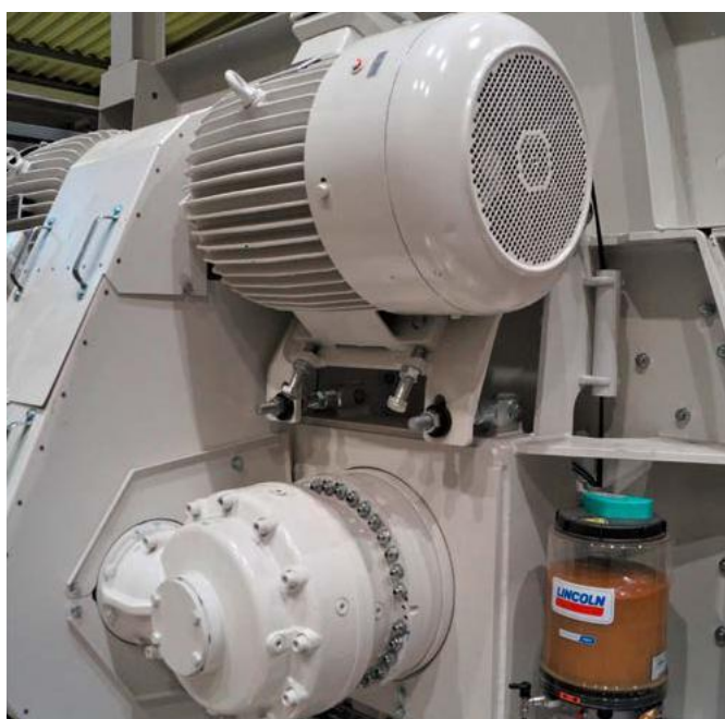
Motorização do misturador com sistema de lubrificação central automática.
