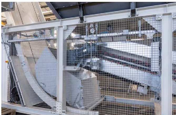
Medição através do cinto de pesagem no balde.
