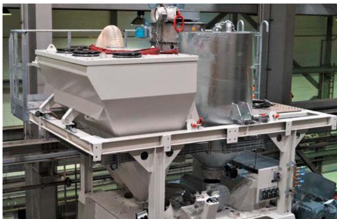
Balanças de pesagem de cimento e água, tal como o sistema anti-poeiras, já vêm pré-montados.
