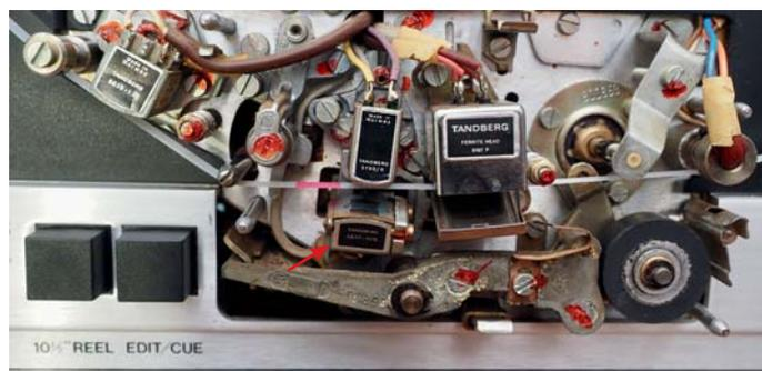
Tonkopfbrücke der »10X /10XD«: Herausragendes technisches Merkmal der ersten wirklichen TANDBERG-Serie war die »Crossfield«-Technologie: Ein zweiter Aufnahmekopf (Pfeil) erzeugt gegenüber dem ersten ein optimiertes Magnetfeld
