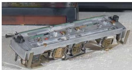
Im Kopfträger sind ein Doppelspalt Ferrit-Löschkopf, Widerlager für die Bandberuhigungsrolle, Aufnahmekopf und Wiedergabekopf aus nicht-magnetischem Anoxinstahl, hinter der Tonwelle der Dia-Impuls- oder der Reverse-Wiedergabekopf sowie insgesamt sechs Bandführungen hängend montiert.
