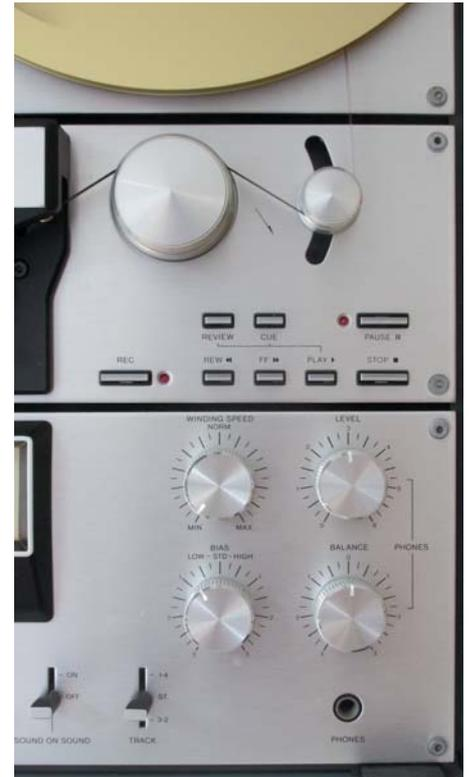
*Mit dem Bias-Regler kann bei der Aufnahme die Vormagnetisierung je nach Bandsorte optimiert werden*
