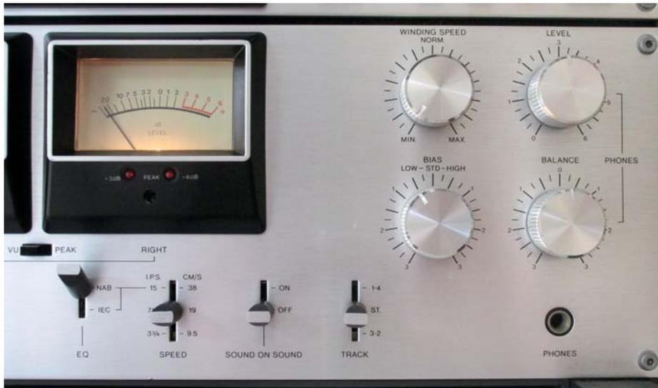
Die übersichtliche Laufwerksbedien­ung wird durch die einstellbare Umspulgeschwindigkeit ergänzt
