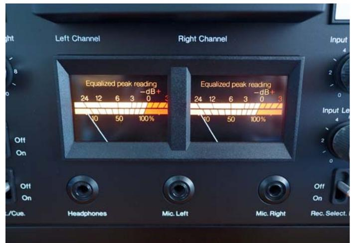
Vergleichsweise riesige Spitzenwert-Anzeigeeinstrumente wurden zum Markenzeichen der TANDBERG-Maschinen, in der »10X/XD« m.E. ästhetisch ansprechender als in der »TD 20A«. TANDBERG legte Wert auf die Feststellung, dass die Instrumente frequenzkorrigiert sind und stets die tatsächlichen Aufnahmepegel anzeigen.
