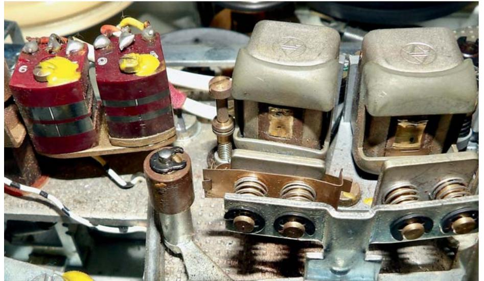
Die Tonköpfe v.l.n.r.: 1/2-Spur Löschkopf, 1/4-Spur Löschkopf, 1/2-Spur Kombikopf, 1/4-Spur Kombikopf
