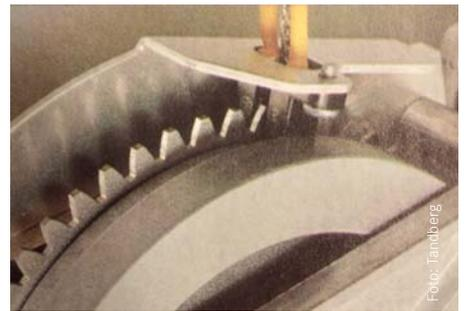
Ein mit kontrollierten Lichtimpulsen arbeitendes Servosystem sorgt in der »10X« für konstanten Gleichlauf
