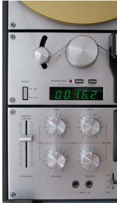
*Der eingebaute Mischer für Line und Mic oder Line und Din möchte bei dem nächsten Aufnahmeprojekt gefordert werden*
