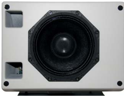
Bild 5: Koaxiallautsprecher des Satelliten mit abgenommener Abdeckung, in der Mitte ist der Hochtöner hinter der Abdeckung zu erkennen
