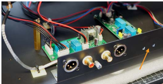
Das Topmodell 1601 bietet gegenüber dem 1600er zusätzlich einen elektrischen Tonarmlift, Endabschaltung sowie symmetrische Ausgänge. Die links im Bild sichtbare Platine steuert Lift und Endabschaltung, die rechte beherbergt die Motorregelung; die Drehzahl-Feineinstellung kann über zwei Regler (33/45, siehe Pfeil) vorgenommen werden.
