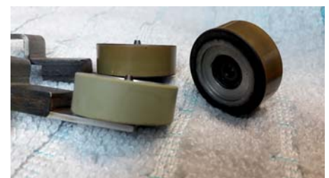
Die Treibräder: Alt und neu im Vergleich
