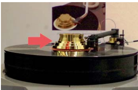
Liftet: The Presslift (roter Pfeil) hebt am Plattenende den Tonarm automatisch ab
