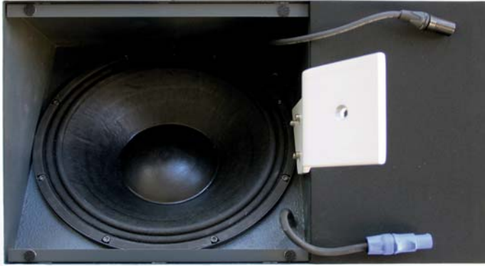
Bild 4: Bassmodul der Standbox von oben gesehen, Abdeckung abgenommen und Satellit demontiert
