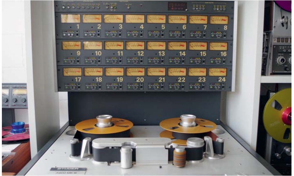
Studer-Maschine A800 MKIII (1977-1988) in einer 24-Kanal-Ausführung
