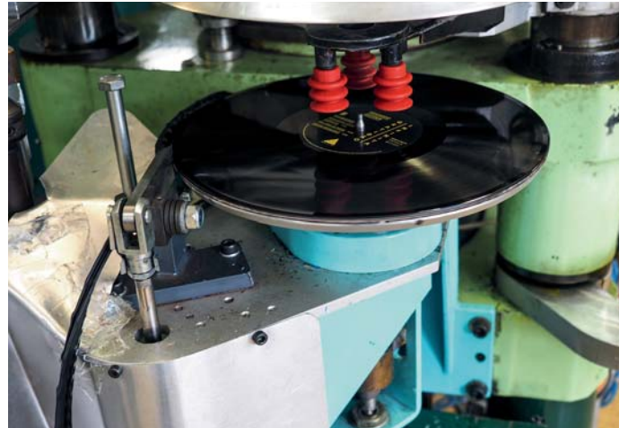
...zur Schallplatte ausgeformt. Die Drehbewegung der frisch gepressten Scheibe führt diese an einem Messer vorbei (links im Bild), wobei in einem Arbeitsgang das überschüssige Randmaterial abgeschnitten wird
