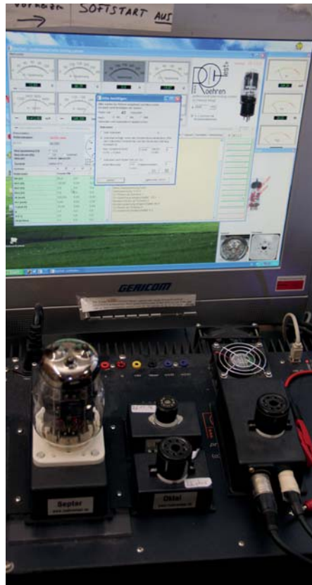
Röhrenmessplatz mit Einschubadapter für verschiedene Typen (hier: 6C33) und Analysesoftware
