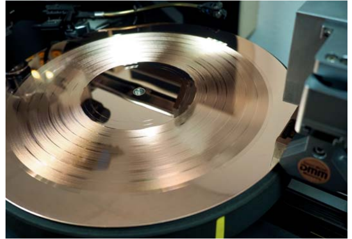
Nicht zu übertreffen: LPs, deren »Mutter« direkt als Kupfermatrize geschnitten wird, sind bei heutigem Ausgangsmaterial klanglich deutlich überlegen
