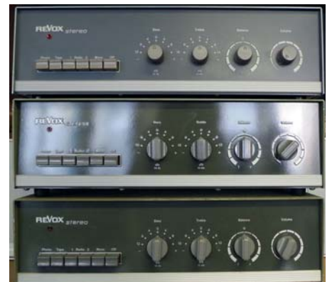
Der erste Stereovorverstärker in Röhrentechnik: Revox 40 (1961-1965)
