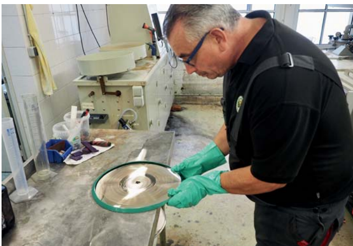
Silbersee: In der Galvanik erhält die Lackfolie zunächst eine Silberschicht, um elektrisch leitfähig zu werden; danach kommt sie ins Nickelbad, in dem sich durch Stromdurchfluss eine nach und nach dicker werdende Schicht dieses Metalls auf dem versilberten Folienschnitt aufbaut
