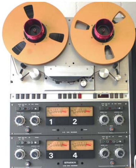
Master-Maschine Studer B67/A 80 (1970) in einer Vier-Kanalausführung
