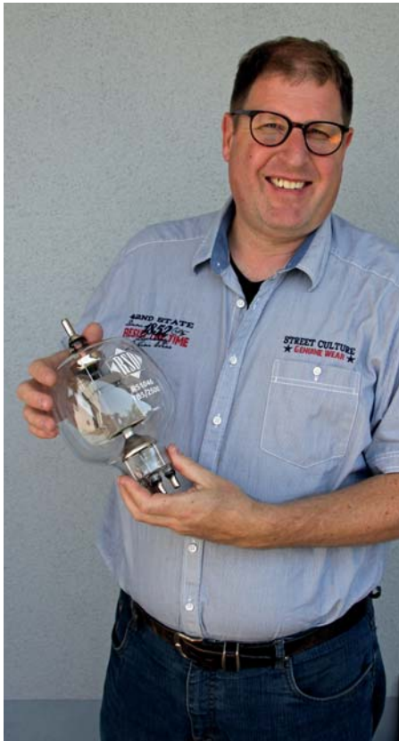
Der Inhaber Michael Kaim präsentiert ein Schmuckstück von RSD Röhre mit der Bezeichnung RS 1046 (Senderöhre für industrielle HF-Generatoren bis 50 MHz)
