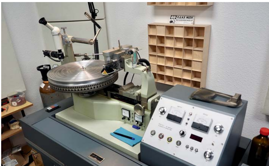
Die NEUMANN VSM 70 ist der Profi für normale Lackschnitte
