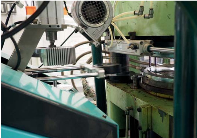
Der noch warme »Kuchen« wird der Presseinheit zugeführt, dort auf optimale Temperatur gebracht und...
