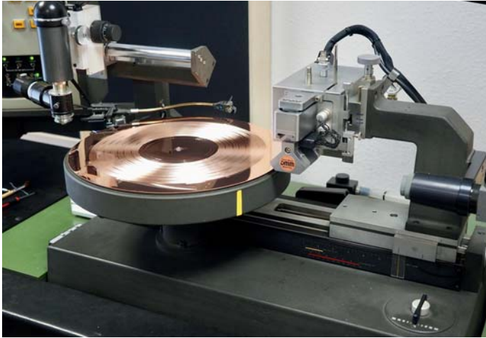
RAND MUZIK verfügt über eine der seltenen DMM-Schneidmaschinen NEUMANN VSM 80, die durch ihren VINYLUM-ULTRA-CUT-Schneidverstärker einzigartig ist
