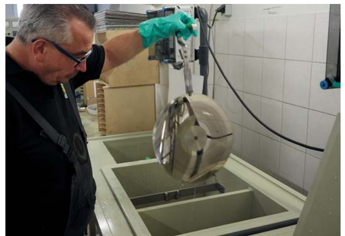
Silbersee: In der Galvanik erhält die Lackfolie zunächst eine Silberschicht, um elektrisch leitfähig zu werden; danach kommt sie ins Nickelbad, in dem sich durch Stromdurchfluss eine nach und nach dicker werdende Schicht dieses Metalls auf dem versilberten Folienschnitt aufbaut
