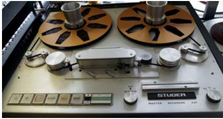
Studer-Mastermaschine A81 (1976) mit umgekehrter/deutscher Schichtlage
