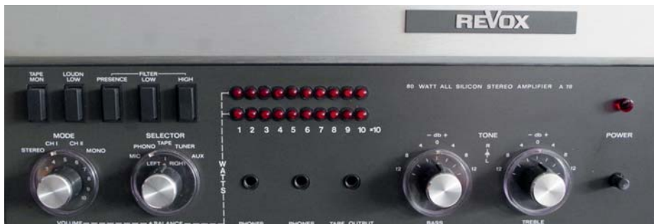
Vollverstärker Revox A 78 (1971-1974) mit mit LED-Leistungsanzeige als Sonderausstattung
