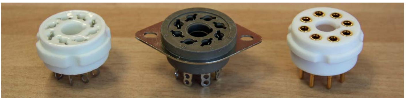
Fassungen für denselben Röhrentypen (von links nach rechts): Keramik, Kunststoff, Teflon
