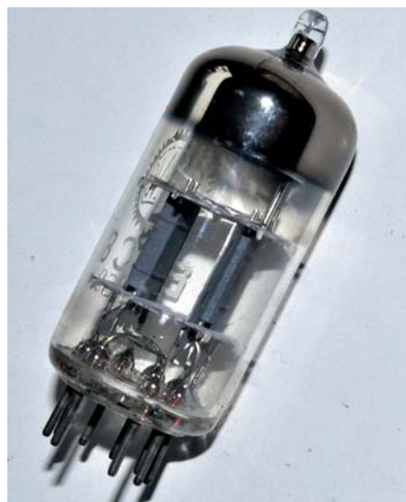
ECC81 - zwei Trioden-Systeme in einem Kolben
