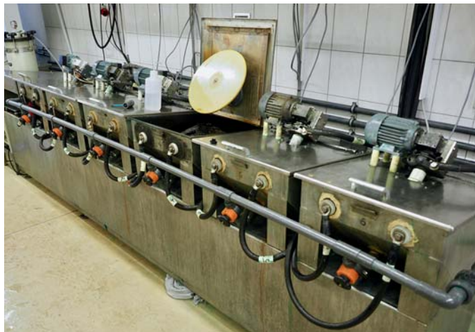
RAND MUZIK verfügt über eine der seltenen DMM-Schneidmaschinen NEUMANN VSM 80, die durch ihren VINYLUM-ULTRA-CUT-Schneidverstärker einzigartig ist
