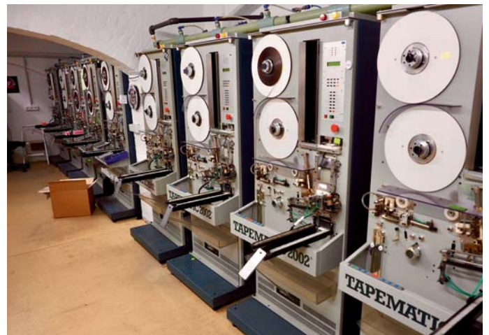
Analog total: Auch für das (insbesondere in den USA stattfindende) Cassetten-Revival hat sich RAND MUZIK in Stellung gebracht – Cassetten-Vervielfältigungsstraße im eigenen Hause
