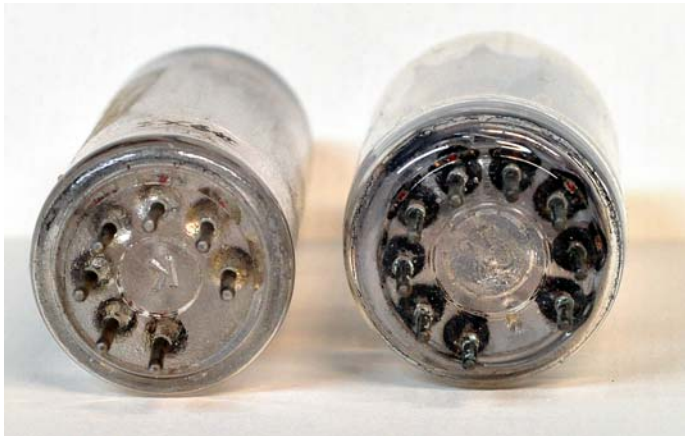
Die beiden häufigsten Röhrensockel
