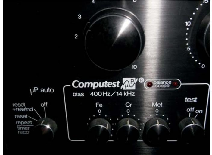
µP auto-Umschalter und Bedieneinheit für den Einmesscomputer
