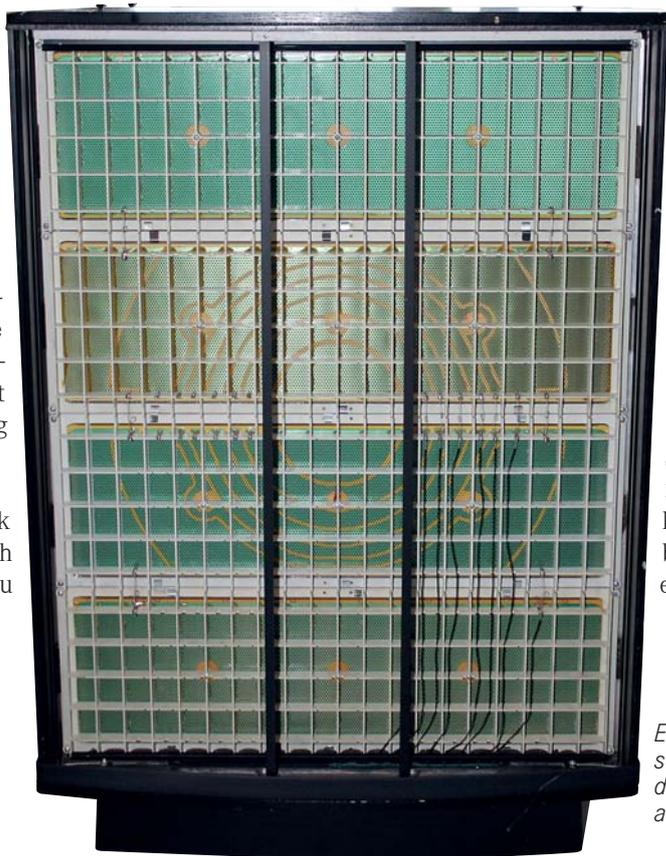
ESL-63 ohne Abdeckung, deutlich zu sehen die kreisförmigen Sektoren von der Mitte nach außen, die zeitversetzt angesteuert werden
