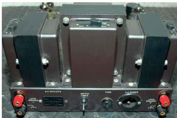
Dicker Hintern: Mittig der Netztrafo, links und rechts die fetten Übertrager
