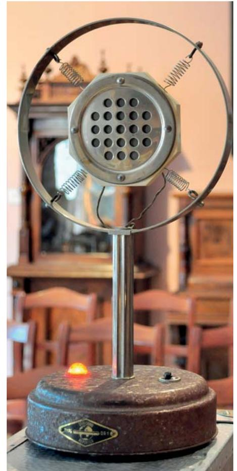
Bild 10: Kohlequerstrommikrofon von 1930
