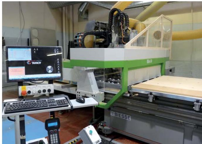
Bearbeitungsautomaten für die Lautsprechergehäuse, CNC gesteuert.
