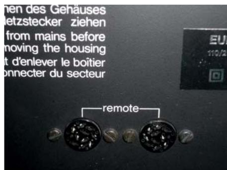
Anschlussmöglichkeit für einen Heimcomputer mit 8 bit-Schnittstelle (z.B. PET Commodore) und einer Fernbedienung. Geräte der ersten Generation hatten nur eine Anschlussbuchse.
