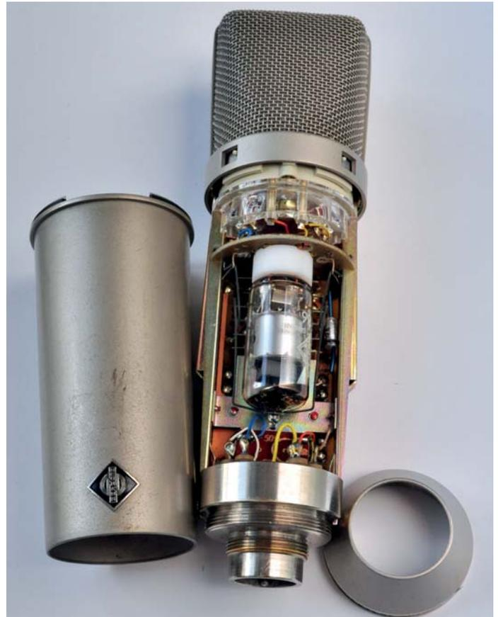
Bild 6: Geöffnetes Neumann U67 Röhrenmikrofon
