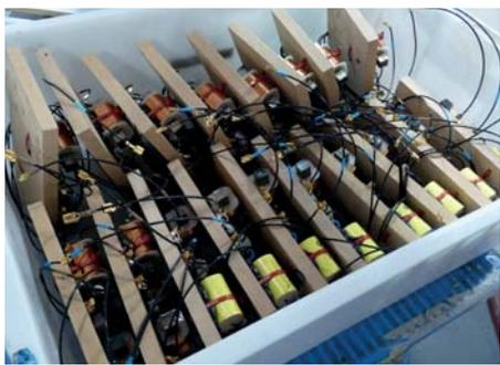
Andere, vorgefertigte Frequenzweichen bereit zum Einbau
