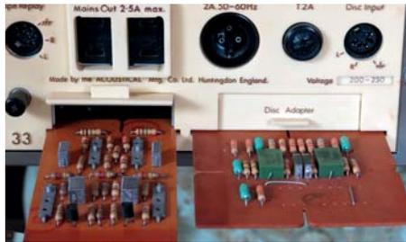
Quad 33 mit den steckbaren Anpassplatten
