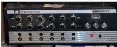
Dynacord Gigant, ein Röhren-Mischverstärker mit 6 Eingängen aus den 60er Jahren
