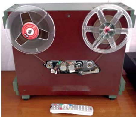
Abgespeckt: Revox A77 als reine Wiedergabemaschine mit Bedienung mittels Infrarotfernbedienung
