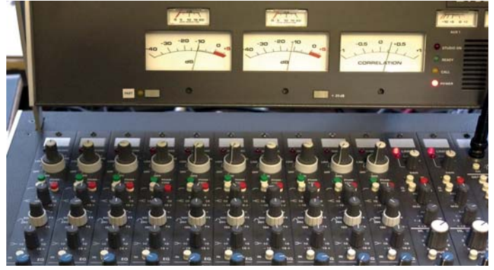
Sorgte bei der Aufnahme für das richtige Mischungsverhältnis: Studer-Mischpult 962
