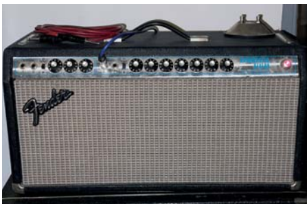
Fender Bandmaster Reverb, 60er Jahre, Gitarren-Röhrenverstärker für zwei Gitarren, 40 Watt.
