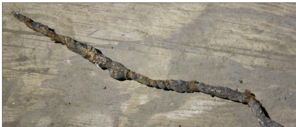
Figur 27. Närbild på del av det tvinnade och tjärdoppade taglet.
