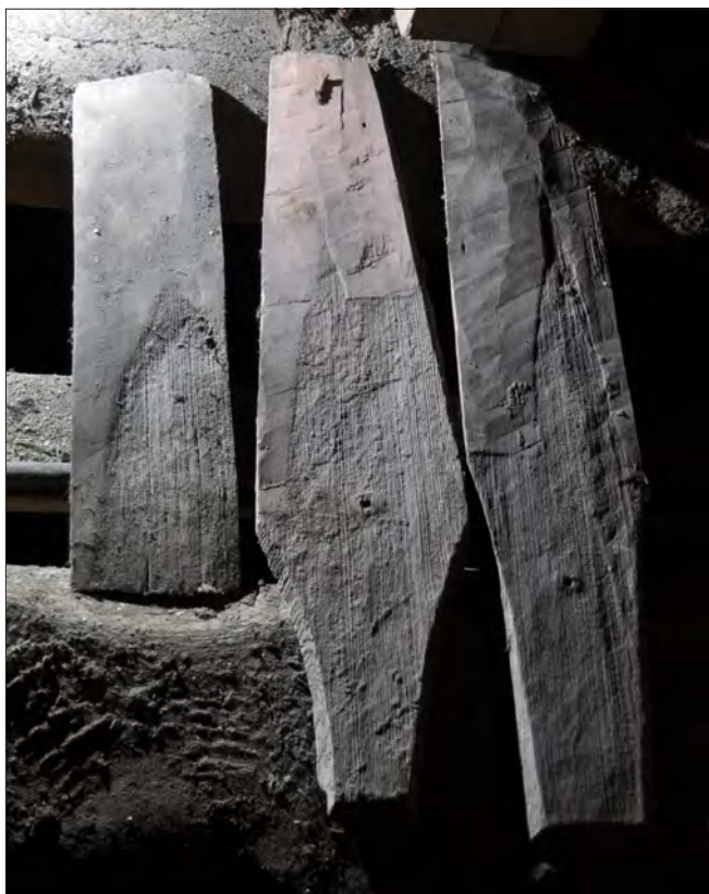
Figur 19. Lösfynd av stanspån av olika modell. Behuggning och överliggande skift syns tydligt i släpljus. Foto Daniel Eriksson.
