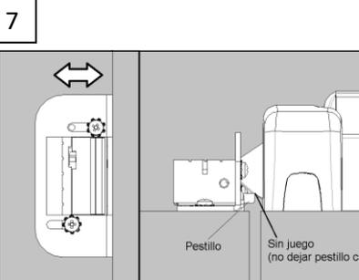
7 Con la puerta cerrada regular posición del pestillo eléctrico para que no quede juego entre el picaporte del anti pánico y el mismo. Evitar dejar cargado el pestillo, ya que de esta forma no podrá liberar eléctricamente, para ello se recomienda el uso de un cierra puerta.
