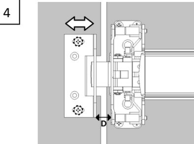
4 Regular la posición del bastidor hasta lograr una distancia de D=15mm(en caso de usar productos T391 o T393, D=17mm) respecto al mecanismo del anti pánico, verificar que ambos queden paralelos y ajustar fuertemente los tornillos.
