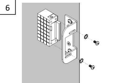
6 Colocar la cerradura eléctrica con sus tornillos (M4x8) y arandelas según la secuencia que se muestra en la imagen.
