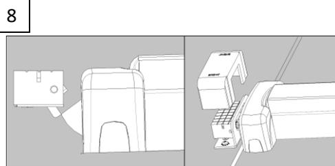
8 Alimentar a la cerradura eléctrica con 12VCA (850mA mínimo) y verificar que el pestillo libera con la puerta cerrada y al abrir permite el paso libre al anti pánico. Finalmente colocar el capuchón a presión.
