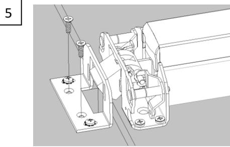
5 Marcar y realizar las perforaciones según lo mencionado en la plantilla para la colocación de los tornillos de fijación cabeza fresada (Parker nº7x5/8"). Fijar los mismos fuertemente.
