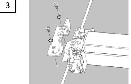
3 Realizar la instalación del anti pánico correspondiente según su manual de instrucción. Colocar el bastidor con sus tornillos (Parker nº8x1/2") y arandelas según la secuencia que se muestra en la imagen.
