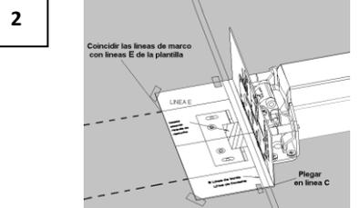
2 Plegar la plantilla en la línea C indicada en la plantilla y apoyar (en forma de escuadra) sobre el mecanismo del anti pánico según se muestra en la imagen. Hacer coincidir las líneas E de la plantilla con las antes realizadas en el punto 1). Realizar las perforaciones y calado correspondiente y continuar la instalación siguiendo a partir del paso 3).
