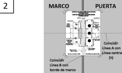
2 Presentar la plantilla según el modelo anti pánico que corresponda, realizar las perforaciones y calado del marco según lo mencionado en la plantilla. Utilizar cinta scotch para realizar la fijación de la plantilla.
