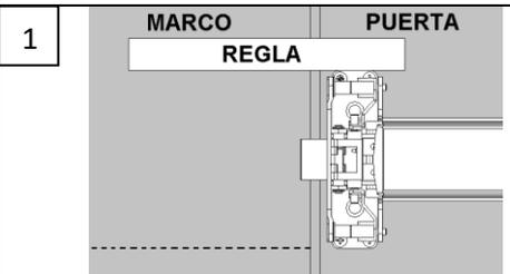
1 Quitar capuchón y tapas del capuchón del anti pánico correspondiente. Trazar una línea paralela respecto del borde superior e inferior del mecanismo del anti pánico, se recomienda la utilización de una regla.
