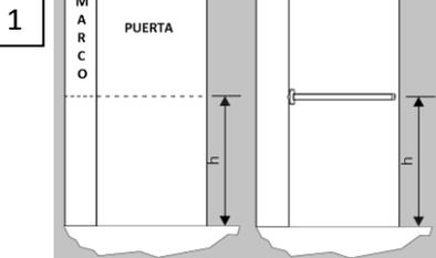
1 Definir la altura del anti pánico(h), y trazar una línea según se muestra en la imagen a una altura entre 900 mm y 1100 mm respecto del piso. En caso de usar un anti pánico de 3 cierres y para puertas mayores a 2100mm de altura, utilizar la altura de instalación h=1100mm.
