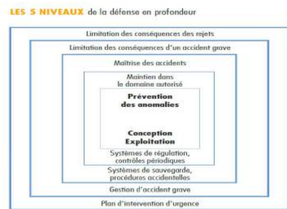
Figure 32 : le principe de sûreté nucléaire « la défense en profondeur »
