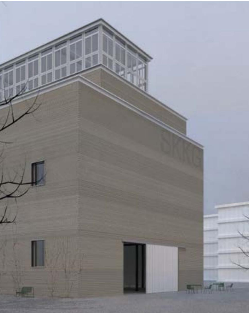
Das Hauptziel dieser kurzen Phase war, unsere gesamte Forschungsarbeit der Wiederverwendung vom Betonverbundstein auf einen grösseren Massstab auszuweiten. Ein Teil davon bildete das Aufzeigen, wie sich der grossflächig verfügbare Stein in einem mehrgeschossigen Hallenbau an der Fassade gestalterisch einbauen lässt.
