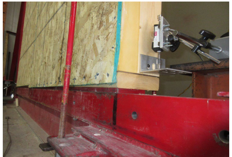
E72-WS-3 - Test Failure
